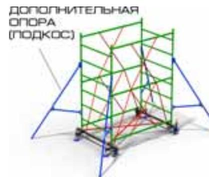
5. В такой последовательности (установка нижних горизонталей, установка боковин, установка верхних горизонталей и затем скрещивающихся стяжек) продолжайте монтаж помоста (туры). Если высота помоста превышает 4м, установите 4 дополнительные опоры.
